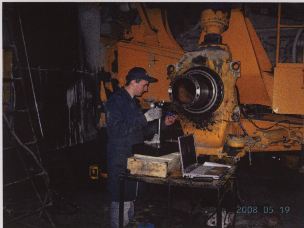
Фото 12. Замеры шероховатости роликов профилографом Hommel Werke T500.
