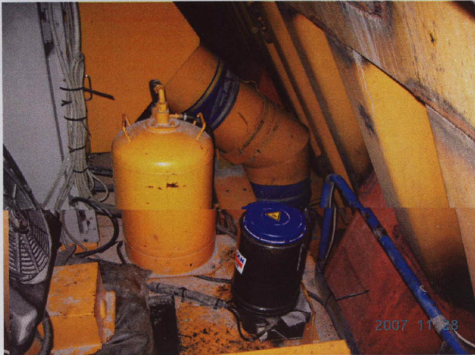
Фото 13. Установка централизованной автоматической системы смазки фирмы LINCOLN установленная на карьерном самосвале.
