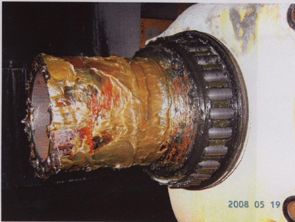
Фото 4. Вал ступицы со смазкой Литол 24 после снятия крышки
